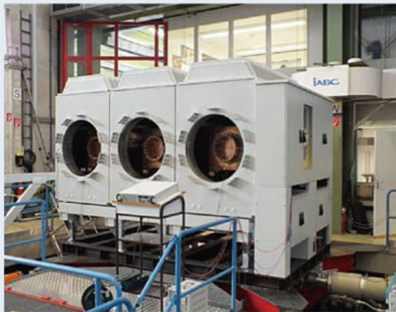
图 53 抗震试验中的 HB3 型开关设备
